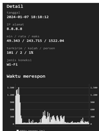
Gambar 16. Pengujian ping kedua ke 8.8.8.8
