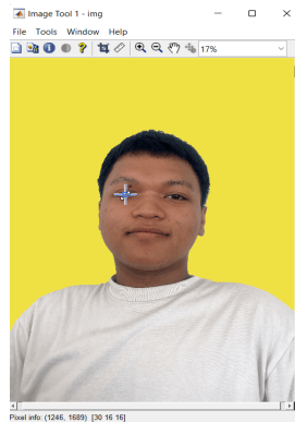
Gambar 7. Mencari titik koordinat (x,y) menggunakan imtool Matlab
