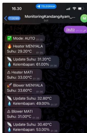
Gambar 8. Hasil Notifikasi Mode Otomatis di Telegram
