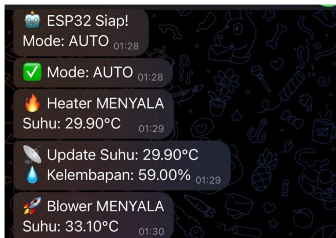
Gambar 6. Hasil Notifikasi Pengujian Sensor Suhu dan Kelembaban di Telegram
