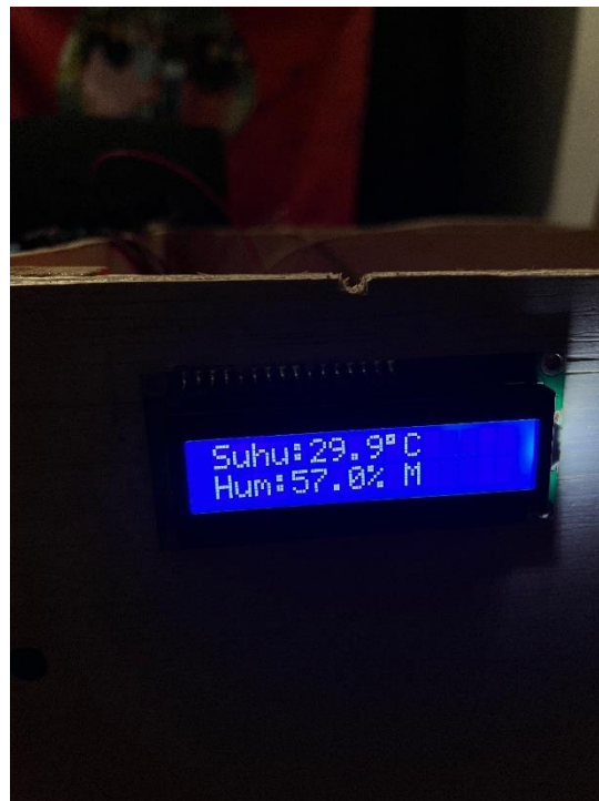
Gambar 7. Hasil Notifikasi Pengujian Sensor Suhu dan Kelembaban di LCD
