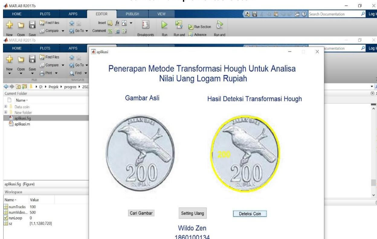
Gambar diatas merupakan proses implementasi sistem dimana pada aplikasi matlab yang telah dibuat menunjukkan hasil bahwa proses metode *transformasi hough* dapat mendeteksi objek yang ada pada sampel citra..
